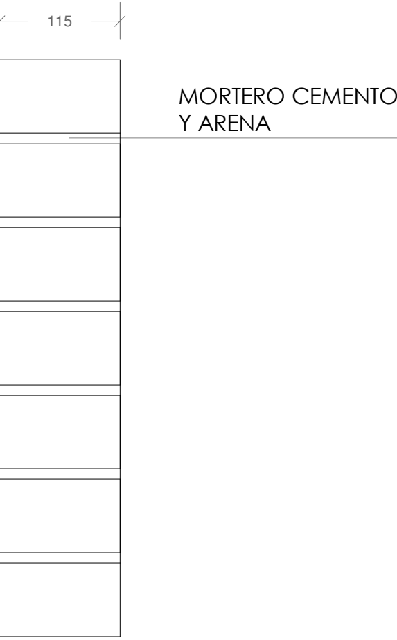
T-12 FABRICA 1/2 PIE LADRILLO MACIZO ACÚSTICO PERFORADO DE 7cm
