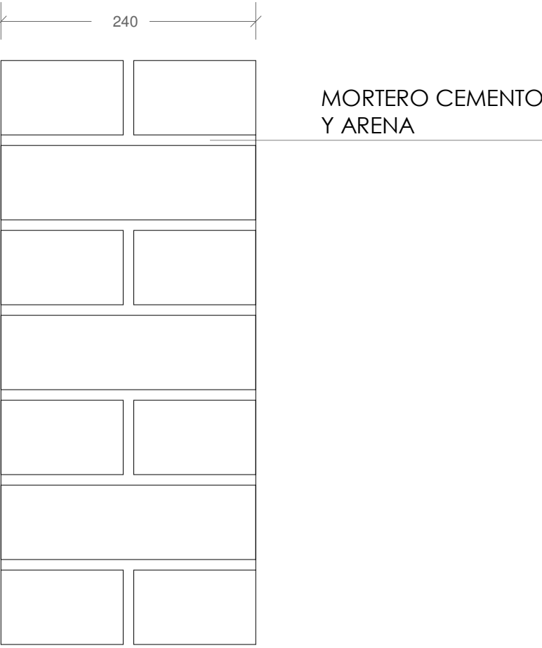
T-13 FABRICA 1 PIE LADRILLO MACIZO PERFORADO 24x11.5x7 cm
